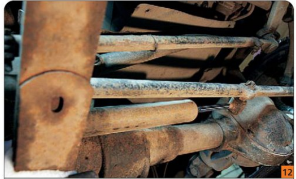
12 Штатный рулевой демпфер обычно не вызывает нареканий. Более того, он неплохо справляется и с увеличенными колесами. Но имейте в виду – тюнинговое изделие в такой ситуации будет работать лучше.
