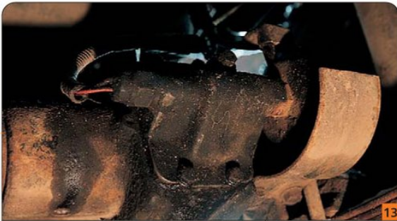
13 Хрупкий механизм размыкания полуоси переднего моста на YJ. А вот и он, большой зуб (фото справа), а точнее, сломанная вилка. Обычно ее стараются заварить и возят с собой, на всякий случай. Радикальным образом эту «хворь» лечат двумя способами: во-первых, меняют вакуумный привод на тросовый, а во-вторых, просто устанавливают неразрезную полуось (3000 рублей за деталь). Кстати, на TJ этот проблемный агрегат уже отсутствует.
