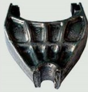
13 Хрупкий механизм размыкания полуоси переднего моста на YJ. А вот и он, большой зуб (фото справа), а точнее, сломанная вилка. Обычно ее стараются заварить и возят с собой, на всякий случай. Радикальным образом эту «хворь» лечат двумя способами: во-первых, меняют вакуумный привод на тросовый, а во-вторых, просто устанавливают неразрезную полуось (3000 рублей за деталь). Кстати, на TJ этот проблемный агрегат уже отсутствует.
