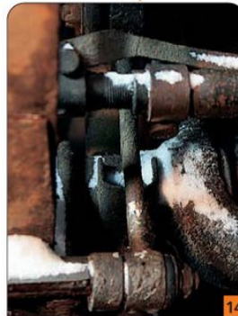
14 Борьба с недостатками крестовин сводится либо к установке специальных усиленных деталей (при цене $40–45 за штуку пробег увеличивается до 60–70 тысяч), либо к их замене на ШРУСы от Grand Cherokee (ходят по 100 тысяч, а стоят 3000–3500 рублей).
