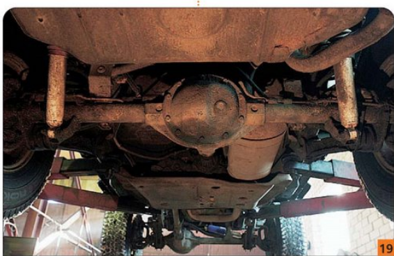
Пружинная подвеска не только придала модели TJ ходы, достойные внедорожника, но и обеспечила больший комфорт.
