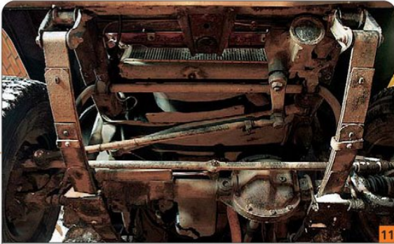
11 Рессорная подвеска модели YJ проверена временем. Ну что тут добавить? Одно «но» – в стремлении сделать машину более управляемой на асфальте она излишне «зажата». Впрочем, это легко лечится...
