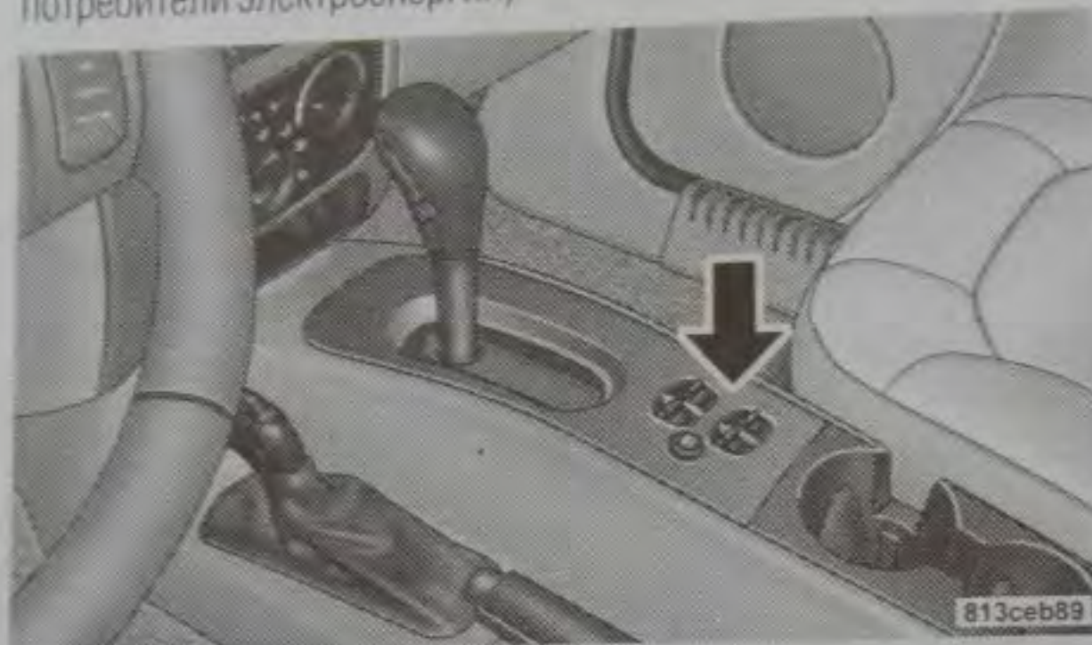
Выключатели электрических стеклоподъемников
